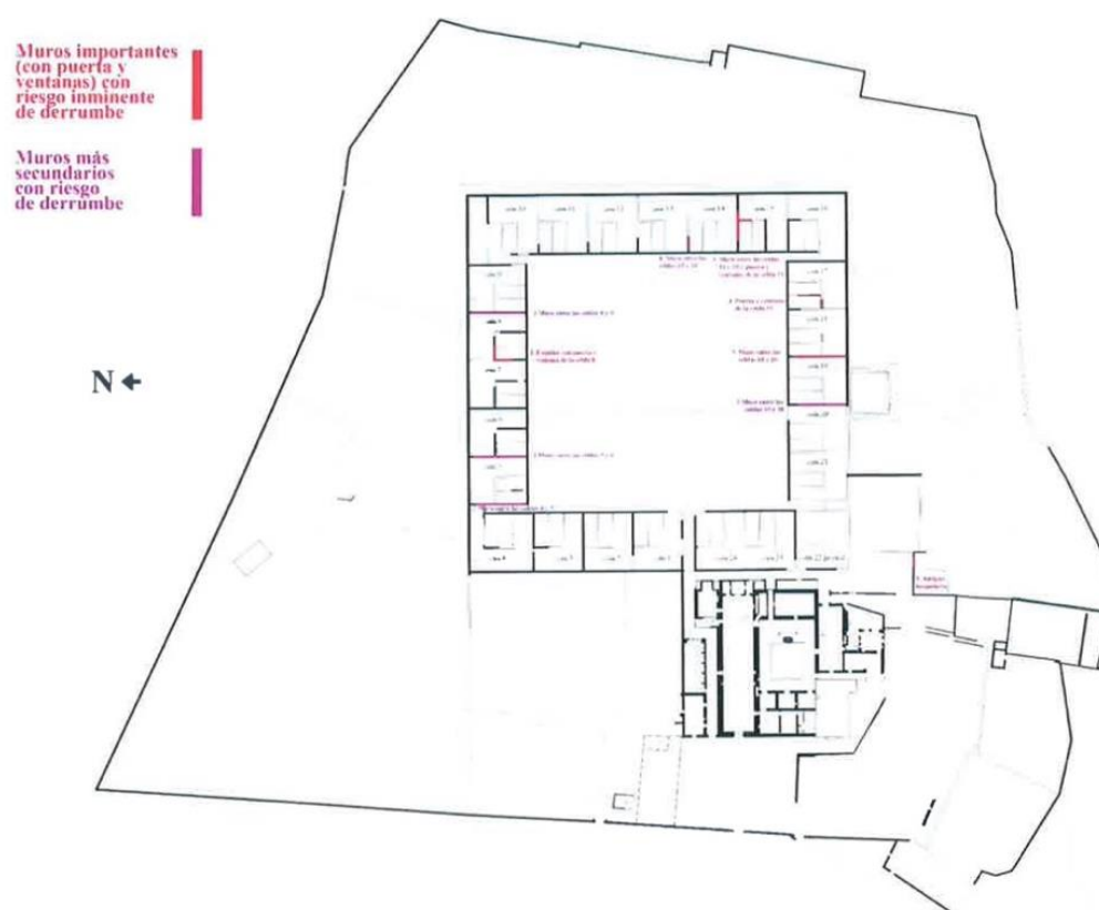
PLANTA GENERAL DE LA CARTUJA DE VALLDECRIST CON SITUACIÓN DE LOS MUROS, PUERTAS Y VENTANAS DE LAS CELDAS Y ANTIGUA HOSPEDERÍA A APUNTALAR POR PELIGRO (INMINENTE) DE DERRUMBE
